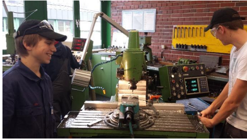
Abbildung 5: Fräsen der Fahrwerksträger Teile
